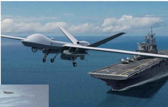
短距離離着陸型機のシーガーディアン、MQ-9B STOL。海自が導入を検討するMQ-9Bの、ウイングとテイルを交換すればSTOL化が可能 画像:GA-ASI
