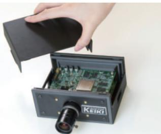
スタンドアローンAIカメラ。ドローン探知アルゴリズムを開発・評価・検証するためのデータ収集装置だ
