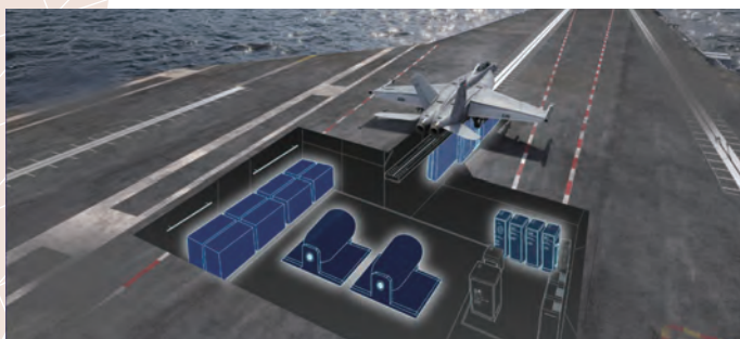
重量にかかわらず空母からの発艦を可能にするEMALS (Electromagnetic Aircraft Launch System) 画像：GA-EMS
