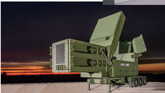
米陸軍向けのレーダーシステム LTAMDS (Lower Tier Air and Missile Defense Sensor) 写真:RTX
