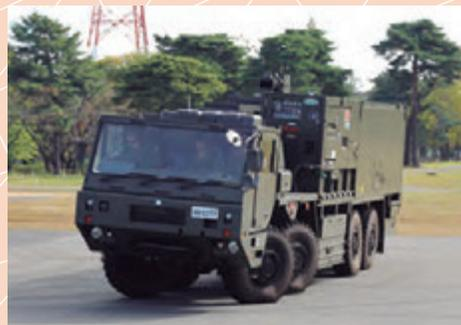
車両搭載高出力レーザ実証装置 写真：鈴崎利治
